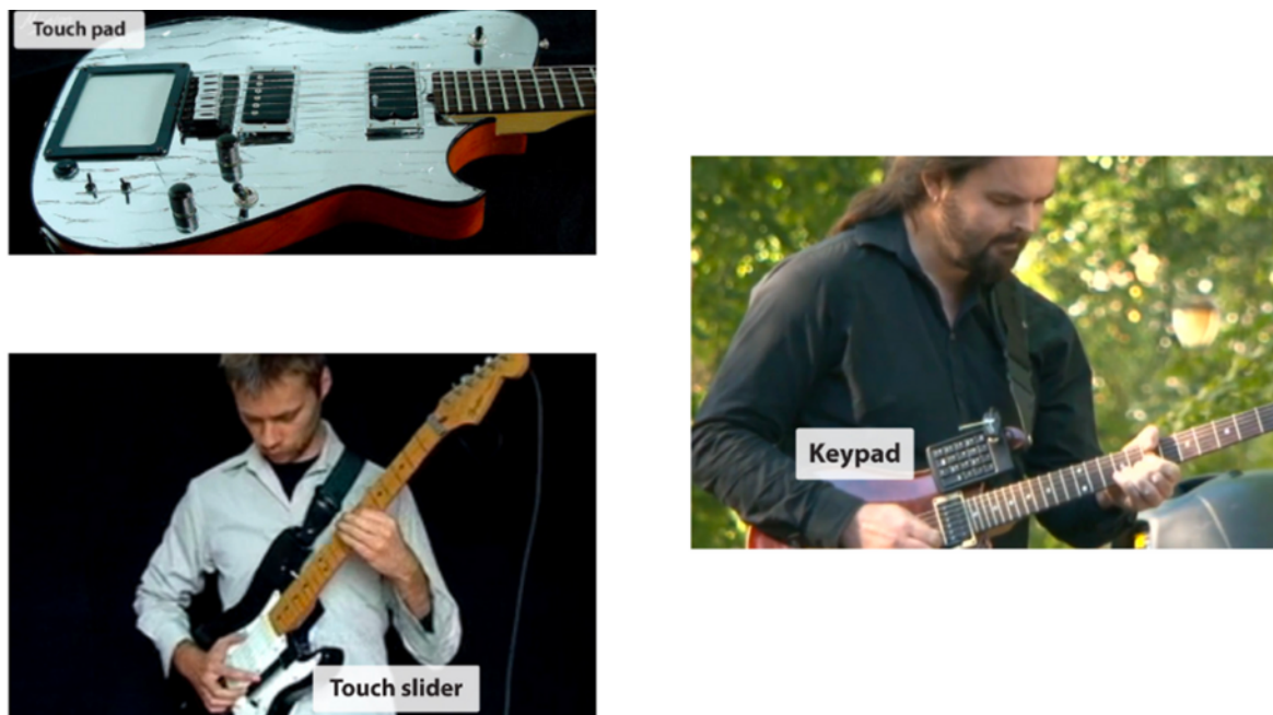
Figura 2-6: Interfaces manuales, arriba guitarra con touchpad de Hugh Manson, debajo guitarra multimodal de Otso Lähdeoja, a la derecha guitarra con keypad Tornd Engum. Adaptado de Exploring the Design Space of Hand-Controlled Guitar Effects for Live Music (Hödl and Fitzpatrick 2013).
